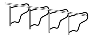
Liegeboxenabtrennung montiert an 2" Rohrpfosten
