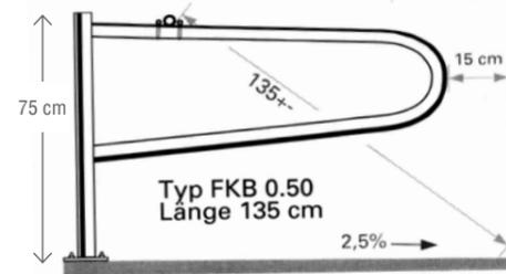
Die Montage der Bügel erfolgt an 2 Tragrohren 1 1/2", bei Einzelreihen dienen pro Bügel 4 Bügelschrauben, bei Doppelreihen 8 Maschinenschrauben als Verbindung zwischen Bügel und Rohr.
