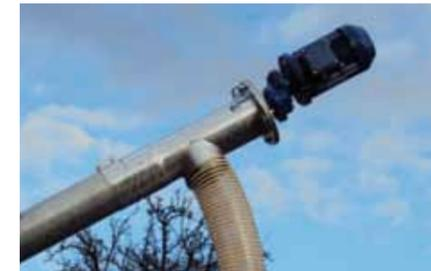
Schneckenantrieb 150 mm mit Getriebemotor 1,5 kw
