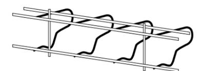
Liegeboxenabtrennung montiert an 2 Querrohren
